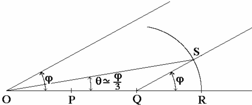
L'angle  $\varphi$  étant donné, on porte sur l'un de ses cotés les points P, Q et R tels que  $OP=PQ=QR$ , de longueur arbitraire. On construit la parallèle à l'autre coté de l'angle, passant par Q. Elle coupe le cercle de centre Q et de rayon QR au point S. L'angle  $\theta$ , défini par OR et OS, est approximativement égal à  $\varphi/3$ . La valeur exacte de  $\theta$  est :
