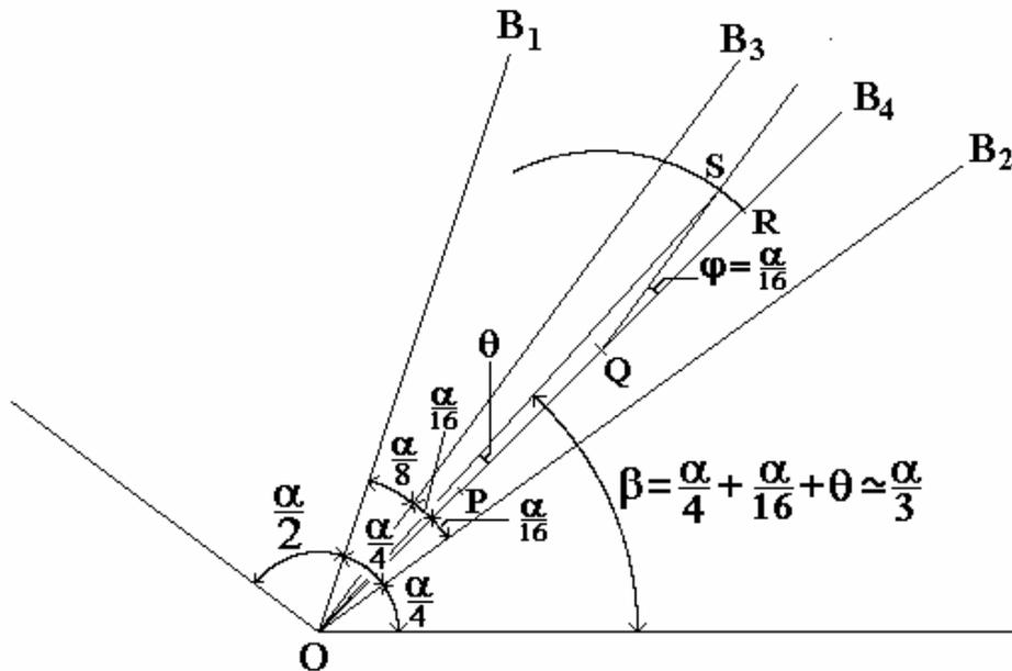
La précision devient excellente : quel que soit  $\alpha$ , l'écart  $\delta$  est inférieur à  $0,006^\circ$ . et si  $\alpha < 102^\circ$  :  $\delta < 0,001^\circ$  ( tout ceci en théorie, car l'épaisseur des traits masque une telle précision)
